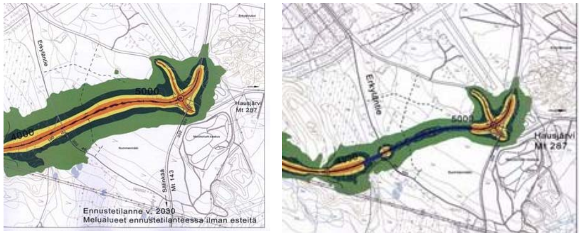
Kuva 8 c kuvaa liikenteen meluennustetta tilanteessa, missä Itäinen ohikulkutie on rakennettu tien yleissuunnitelman mukaisesti ilman melusuojausta. Ote itäisen ohikulkutien yleissuunnitelmasta
